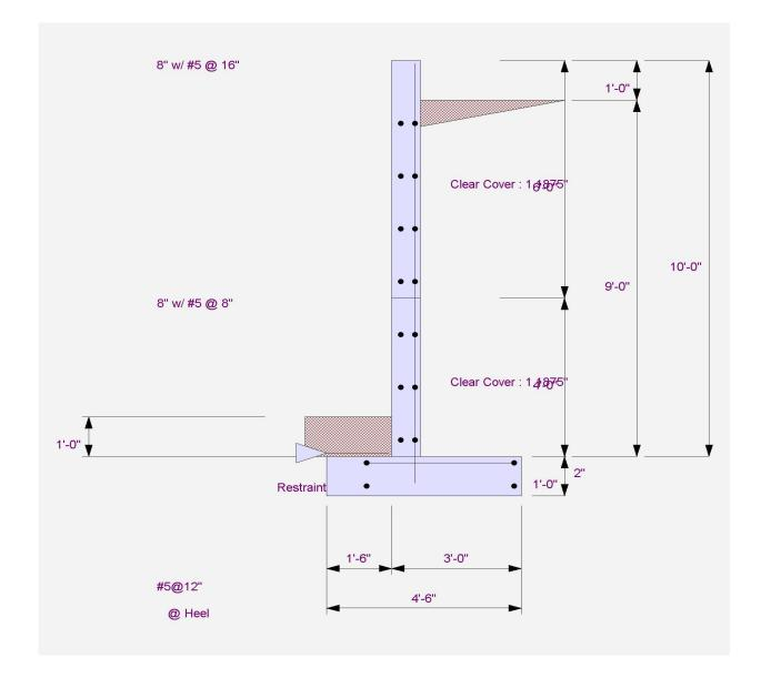
Cantilevered Retaining Wall LIC# : KW-06017913, Build:20.23.04.05
