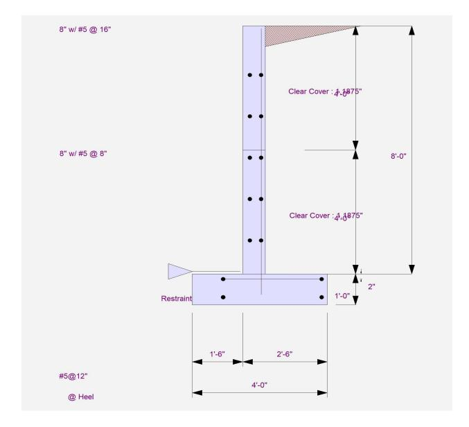
Cantilevered Retaining Wall LIC# : KW-06017913, Build:20.23.04.05
